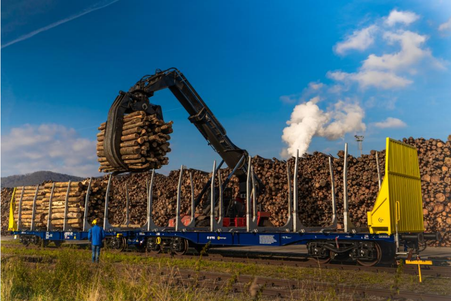
90ft (2x45ft InnoWaggon mit Rungensystem)
